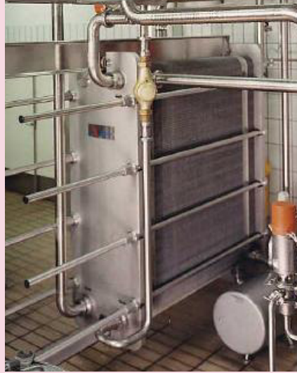
Şekil-4.5 Bir plakalı ve çerçeveli tip ısı değıştircisinin süreç uygulaması
