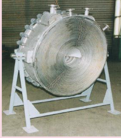
Şekil-4.19 Uç kapağı çıkarılmış spiral ısı değıştirci (bir spiral kanalına erişim sağlama)
