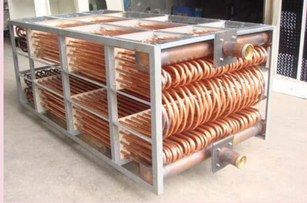
Şekil-10.41 Su püskürtmeli ısı değiştiricisi (Kaynak: YTO)
